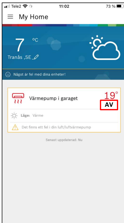
Larm-notis som blockerar kompressorn
